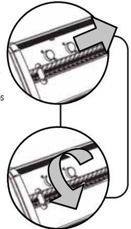
1. Tourner le starter dans le sens inverse des aiguilles d'une montre.
